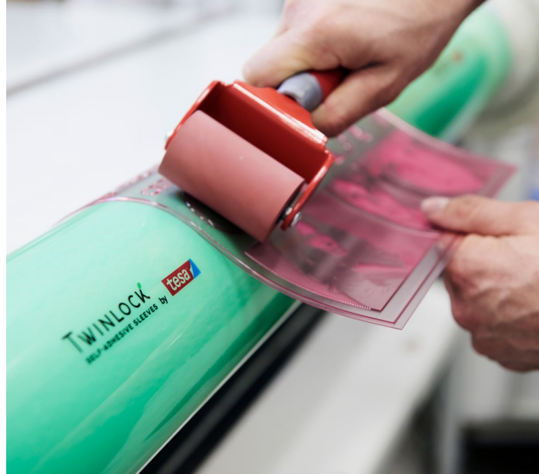
Die Druckplatte lässt sich direkt auf den beschichteten tesa® Twinlock-Sleeve aufbringen und problemlos wieder entfernen. Klischeeklebebänder werden so vermieden – und Abfall und Transportemissionen ebenfalls.
